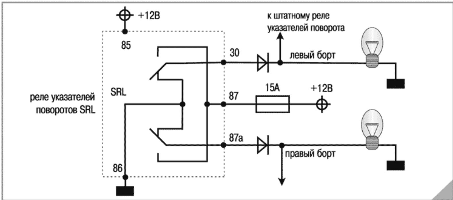
Предназначено для управления указателями поворота. Питание +12V на указатели должно подключаться через предохранитель.
