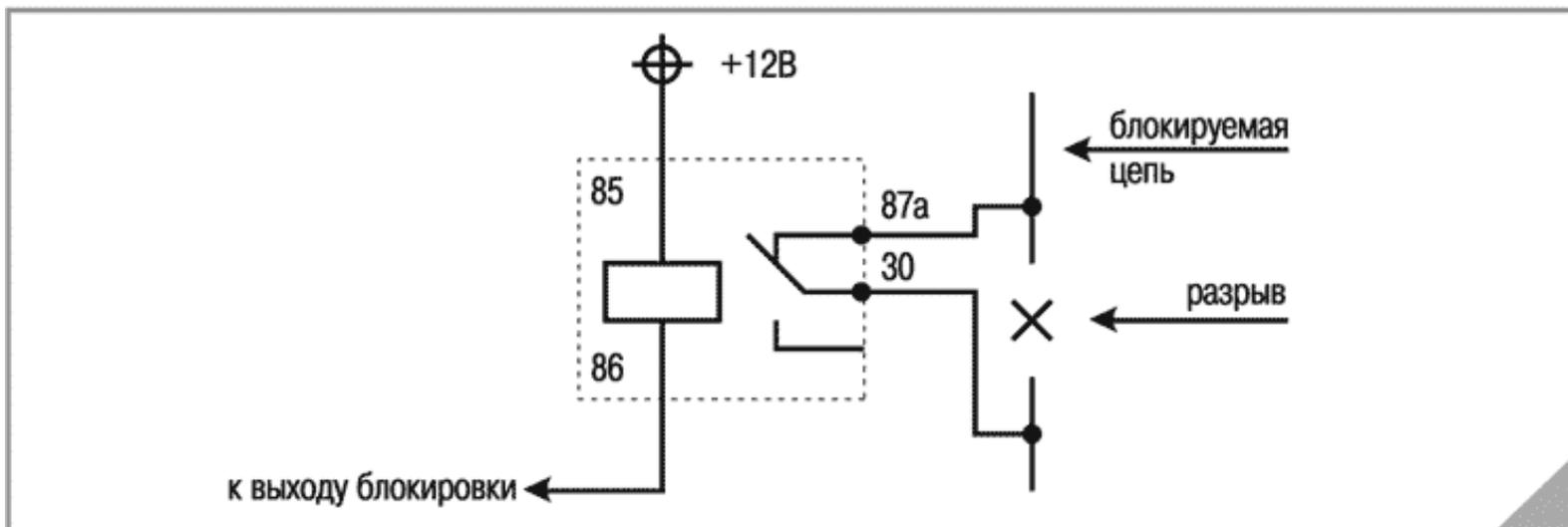
При активной блокировке разрываемая цепь подключается к нормально замкнутым контактам реле. Двигатель блокируется (контакты реле размыкаются, разрывая цепь) при включении зажигания в режиме тревога.
