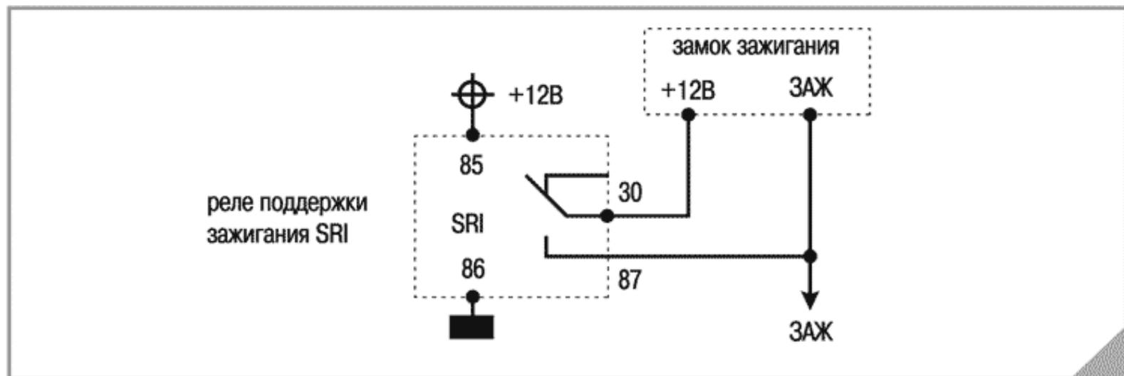
Турбо-таймер (т.е. реле поддержки зажигания) включается на 30 секунд, если перевести АКПП в положение ПАРК (вытянуть "ручник") при работающем двигателе. Для работы турбо-таймера необходимо, чтобы один из входов системы был подключен к "ручнику" или датчику положения ПАРК. Вам потребуется переназначить, например, вход "капот" на этот датчик при помощи компьютерного программы. Концевой выключатель капота при этом подключается параллельно концевому выключателю багажника.
