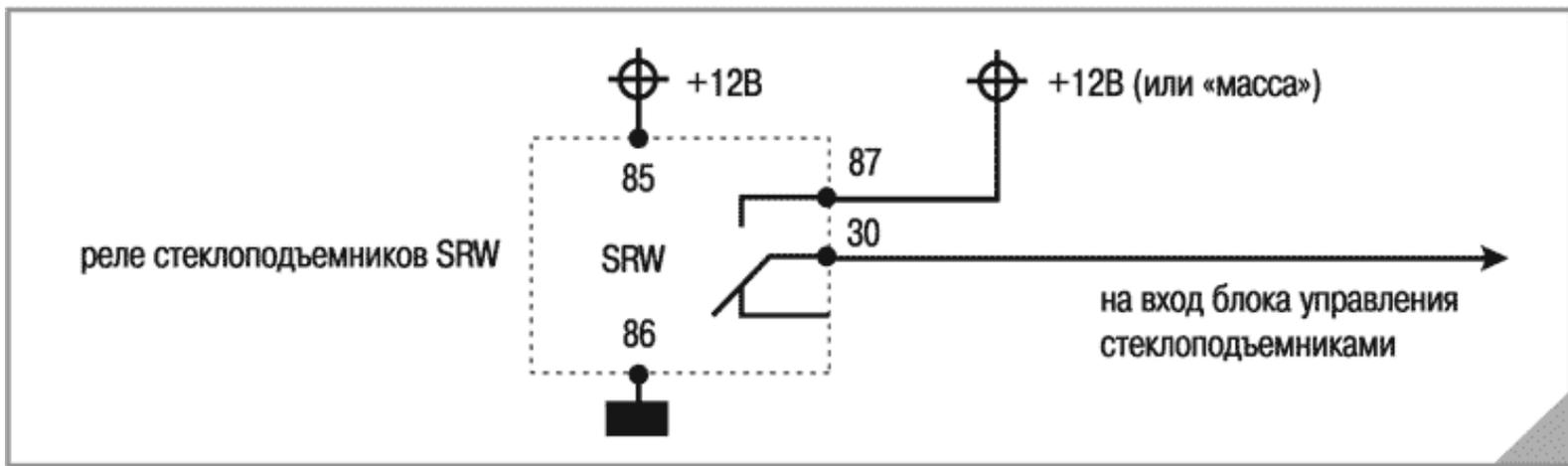
**Автоматического режима нет.** Потребуется блок управления стеклоподъемниками, обеспечивающий отключение их двигателей при достижении крайних положений.
