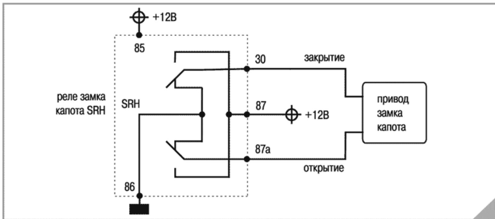
Предназначено для управления электроприводом замка капота в системах без сирены Magic Voice. Длительность импульсов можно изменить с помощью программы Magic Tuner. Команда закрытия замка капота подается при постановке в охрану, если выключено зажигание и капот закрыт. Команда открытия замка капота подается при снятии с охраны, если ранее замок капота был закрыт.
