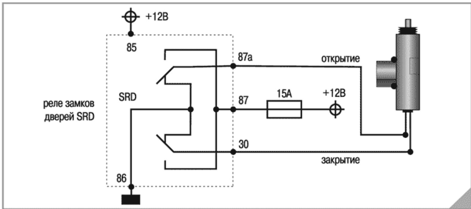
Предназначено для управления приводами замков дверей. Питание +12V приводов замков должно подключаться через предохранитель.
