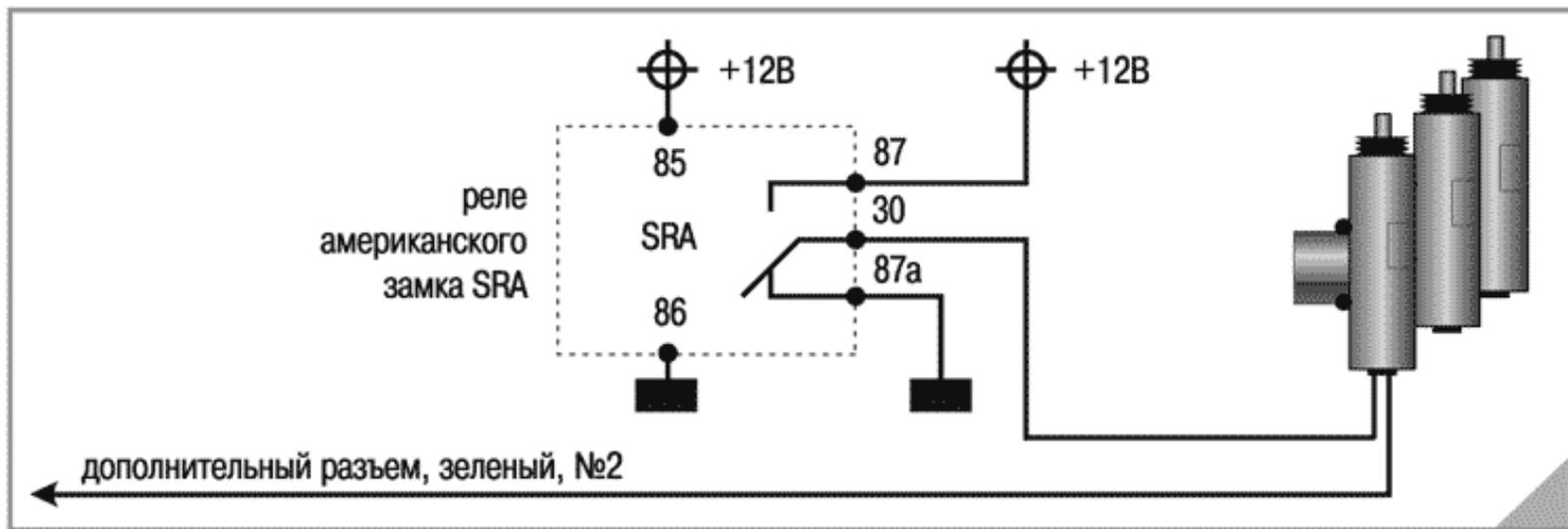
Предназначено для управления приводами замков дверей пассажиров при подключении американского центрального замка. Приводы дверей пассажиров подключается по приведенной схеме, дверь водителя - как обычно.
