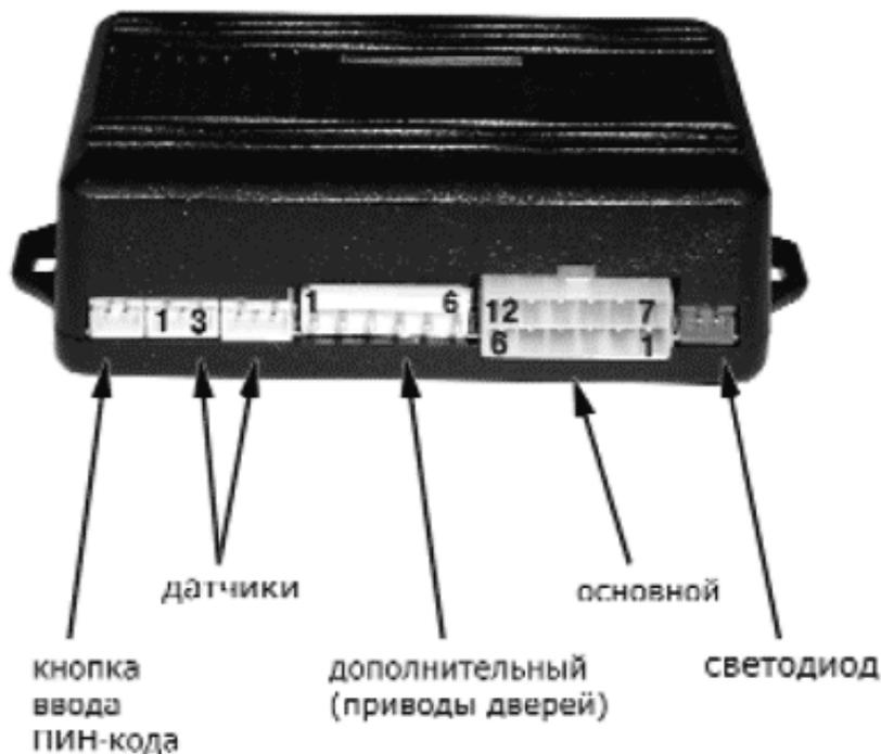
Приведенные ниже схемы и назначения проводов соответствуют заводской настройке системы и могут быть изменены при компьютерном программировании.
