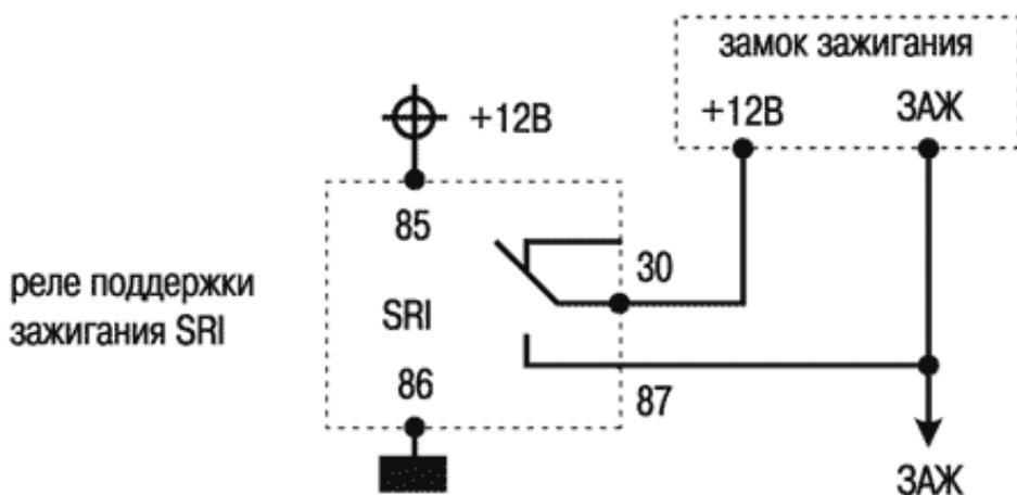
Предназначено для включения поддержки зажигания, если нет необходимости в дистанционном запуске, например, для обеспечения режима турбо-таймера.
