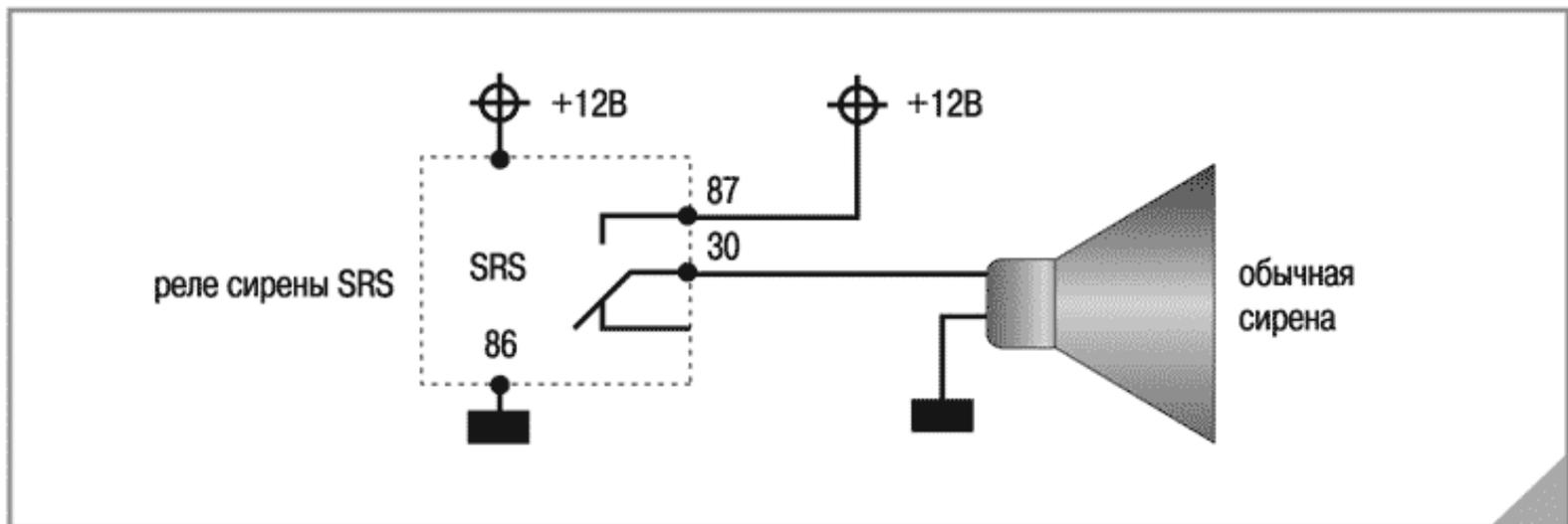
Предназначено для управления обычной сиреной в системах, не имеющих sireны Magic Voice.
