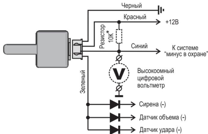
\*Резистор 10кОм установить, если напряжение на синем проводе в состоянии снято с охраны меньше 3 Вольт.
