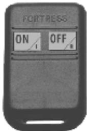
Для того, чтобы поставить систему на охрану (взять автомобиль под охрану), необходимо нажать и отпустить кнопку ON брелка. Система подаст два коротких звуковых сигнала и два световых (указателями поворота) сигнала. Зажигание заблокируется. Если установлены и подключены приводы замков дверей, кнопки дверей опустятся. Система перейдет в режим ДИАГНОСТИКИ ДАТЧИКОВ.
