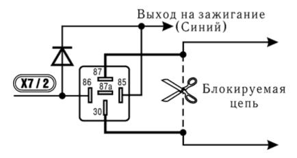
Если при запрещении работы с дистанционно управляемыми реле HOOK AS или HOOK DS Вы используете выход X7/2 для управления реле блокировки, то питание реле необходимо осуществлять от цепей, на которых появляется и присутствует напряжение +12 В при включении зажигания.
