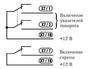
Для подключения сирены используется нормально разомкнутый контакт реле (X7/7). Напряжение "+12 В" поступает на реле по проводу X7/18 через предохранитель 5 А.
