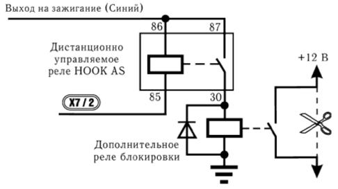
Дистанционно управляемые реле HOOK AS рассчитаны на блокировку цепей с током не более 20 А. Для блокировки цепей с большим током необходимо использовать дополнительное реле.
