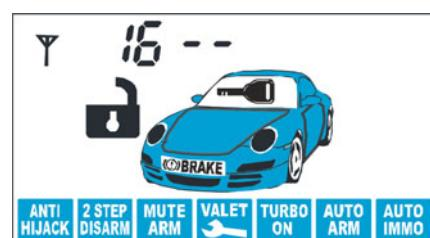
**вариант 4** - работа канала в режиме поддержки +12В на контакте IGN1 (15/1) замка зажигания при активизации режима охраны с работающим двигателем. Поддержка зажигания происходит автоматически при работающем двигателе (или включенном зажигании) при затягивании ручного тормоза. Время нахождения в режиме поддержки зажигания не ограничено. Поддержка будет выключена при выключении зажигания или при отпусканье ручного тормоза.
