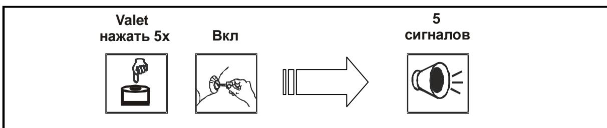
3. Нажимайте сервисную кнопку VALET для продвижения по функциям от 1 до 14. Каждое нажатие сервисной кнопки выбирает очередную по номеру функцию. Номер выбранной функции отображается вспышками светодиода и сигналами сирены. Расшифровка сигналов сирены и вспышек приведена внизу в таблице.
