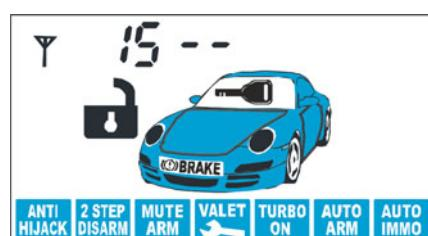
**вариант 4** - работа канала в режиме «зашелка», когда включение / выключение канала осуществляется дистанционно с брелка. На время работы канала в режиме охраны датчик удара и дополнительные датчики не отключаются.
