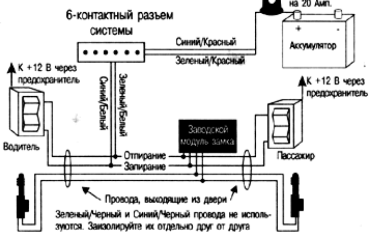
Схема 2. Положительный триггер (большинство легковых автомобилей марки Джeneral Моторс)
