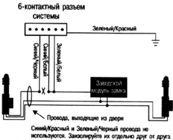
Схема 5. Однопроводный тип цепи дверных замков с отрицательной полярностью (некоторые автомобили марки Ниссан и Mazda)
