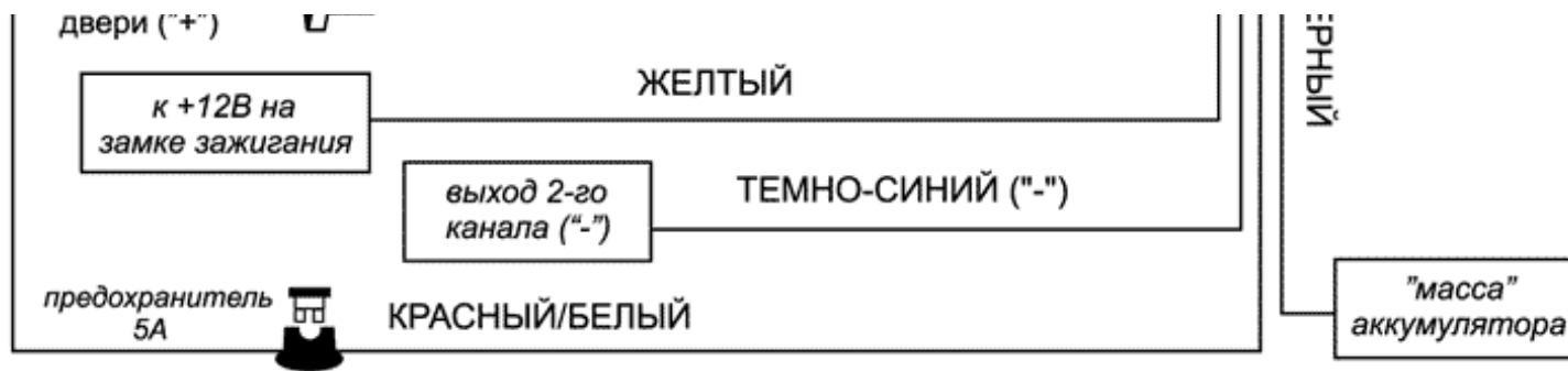
Схема 1. 3-проводная система центрального замка, управляемая сигналом отрицательной полярности (большинство автомобилей японского производства)
